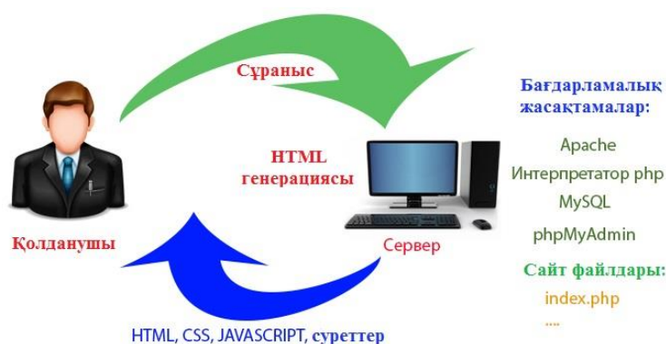
3-сурет. Пайдаланушы мен веб-сервермен өзара әрекеттесу схемасы
